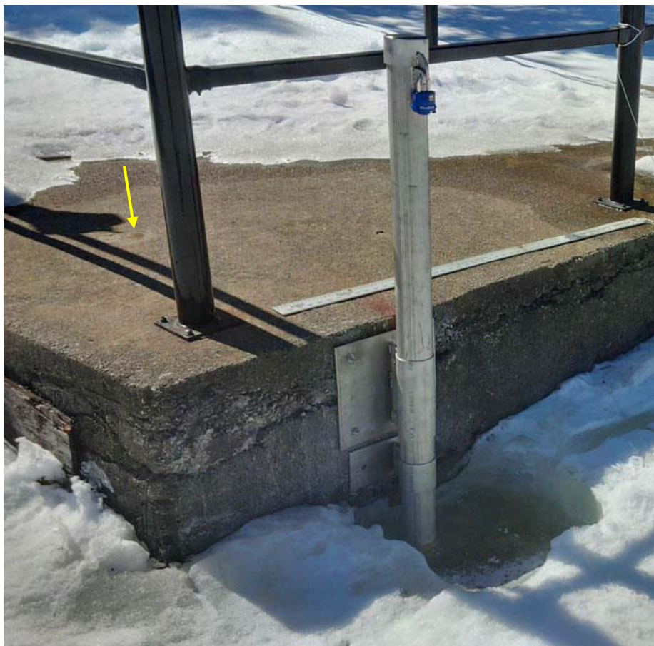
Figure 1. Enceinte du capteur de pression (hydrostatique+atmosphérique) installé le 12 avril 2016 au quai des Clercs de Saint-Viateur montrant la localisation (flèche jaune) de la borne géodésique MRN 92K2229.
